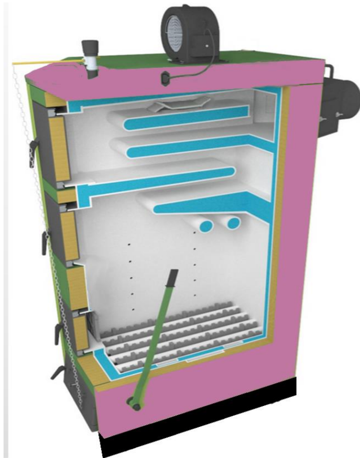
konstrukcja przystosowana do „górnego spalania”
